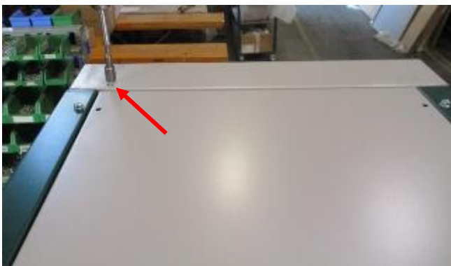
Die Tür oben mit Schraube M6x30 befestigen.
