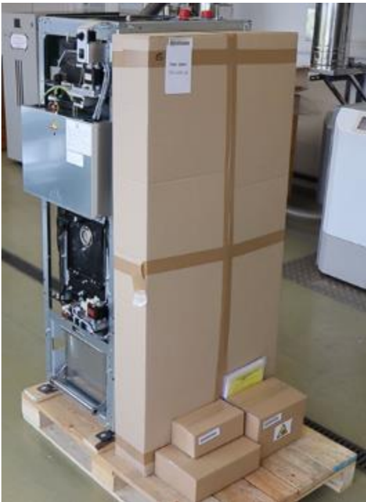
Kessel verschraubt auf Palette, Zubehör und Verkleidung im Karton verpackt.
