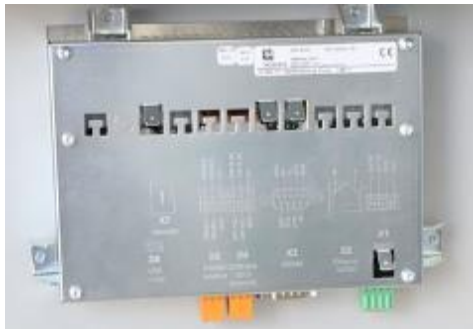
Display T-Control mit Halteklammern und Schrauben an der Verkleidungstür vorne befestigen (ACHTUNG: Schrauben nur „Handfest“ verschrauben!).
