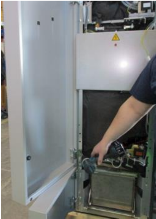
Ansicht Verkleidungstüren rechts zu öffnen (Scharniere können auch links montiert werden).
