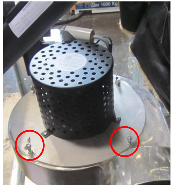
Lösen der Flügelmuttern des Ventilators
