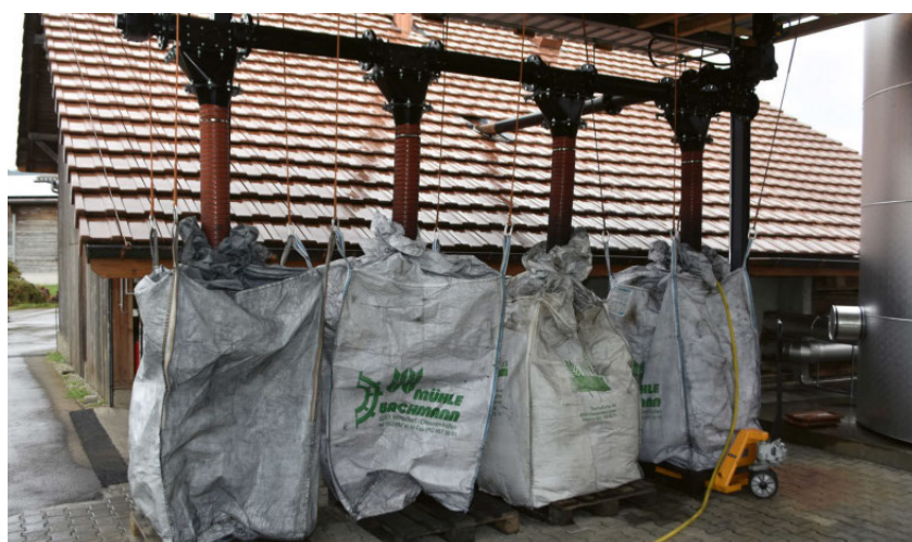
Als Abfallprodukt entsteht Kohle, die in Säcke abgefüllt wird und in der Landwirtschaft als Bodenverbesserer eingesetzt werden soll.
