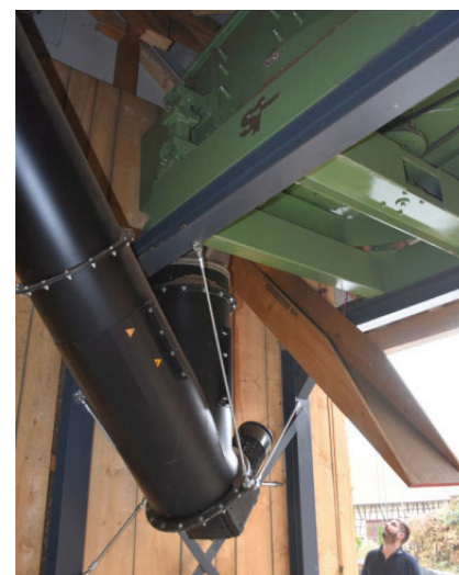
Die Hackschnitzel gelangen vom unterirdischen Fülltrog unter das Dach, wo der Dreck ausgesiebt wird. Ein spezielles Sieb trennt im Nebenraum das Ausgangsmaterial vom Dreck, der direkt abgefahren werden kann.
