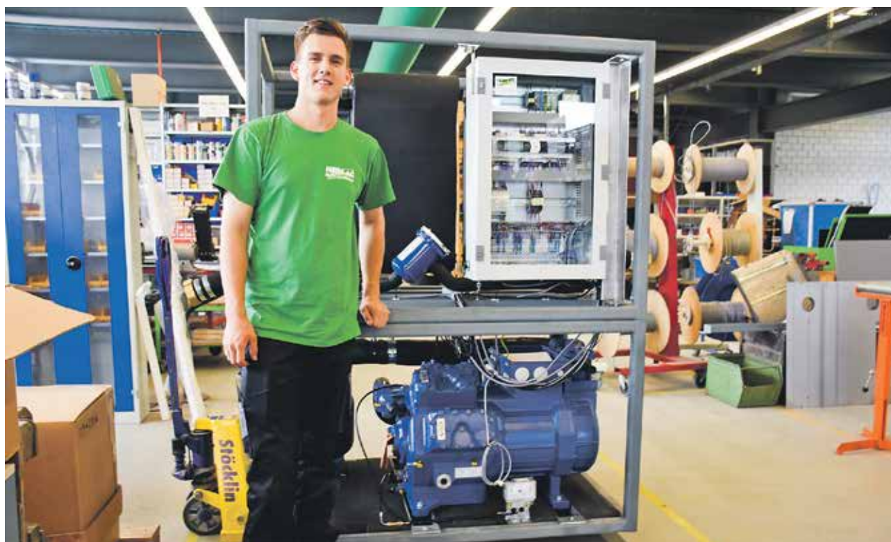
Jonathan Frei vor einer Quellwasserwärmepumpe, die bald 16 Mehrfamilienhäuser in Pfungen beheizen wird.
