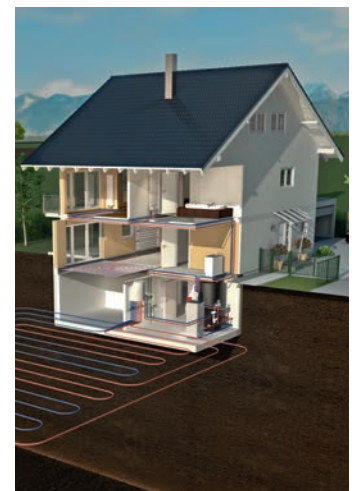
Sole/Wasser-Wärmepumpe mit Erdkollektoren
