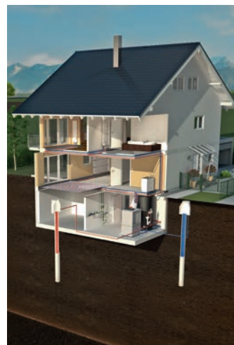
Sole/Wasser-Wärmepumpe mit Erdsonden
