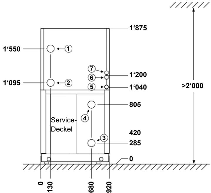
Grundriss (eine oder mehrere Wärmepumpen)
